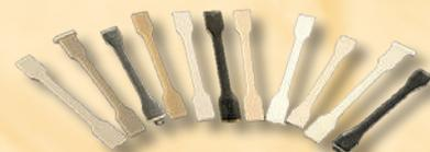
▲ Eprouvettes d'agromatériaux pour tests et caractérisation
